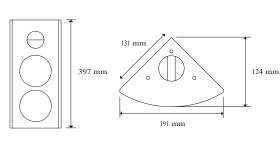
额定功率, IEC268: 80W 峰值功率: 320W 灵敏度, 2,83V/1m: 86 dB 最大SPL、长期: 105 dB 最大SPL,峰值: 111 dB 频率响应: 65-25.000 Hz 额定阻抗: 80 覆盖面: 120x120度 重量::
